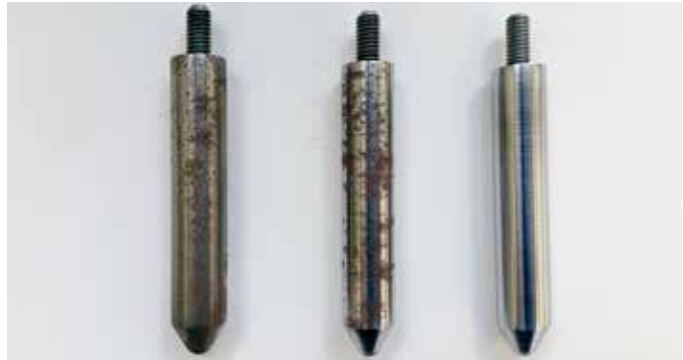
Abbildung 1: Weißmetallstäbe, 24h bei 60 °C umspült: ADDINOL Turbine Oil CA (rechts) weist im Gegensatz zu konventionellen Turbinenölen (links und Mitte) keine Spuren von Korrosion auf
